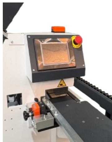
Panel sterowania z ekranem dotykowym 5,6"
